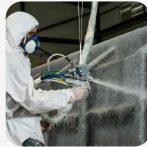
6. Aufspritzen von Glasfaser und Harz
