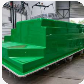
1. Vorbereitung der Form Ihres Pools
